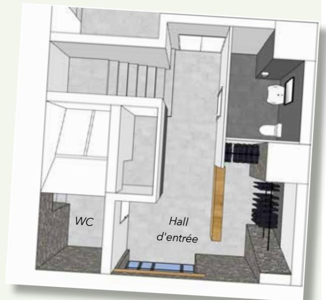
Plans d'aménagement d'un WC PMR au niveau du Hall d'entrée de la salle du Four à Chaux
